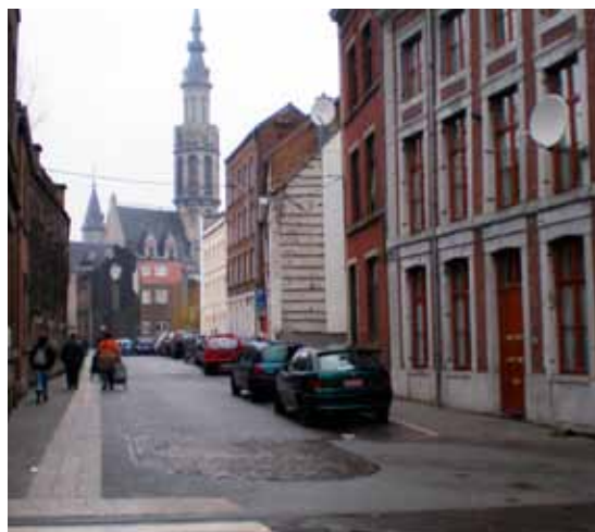
Verviers. Le gestionnaire a prévu une ligne guide tout le long de la voirie. Cet aménagement est quelque peu exagéré. La ligne guide est positionnée du côté où, aucune entrée ou activité n'est localisée.
