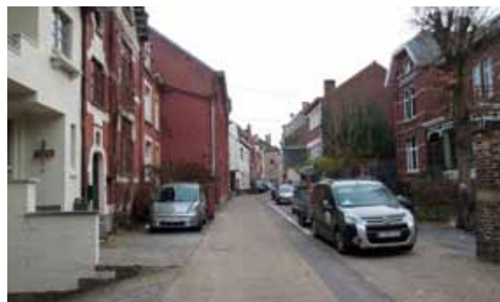
Ottignies, rue Lucas. La voirie n'est pas scindée en chaussée et trottoir.
